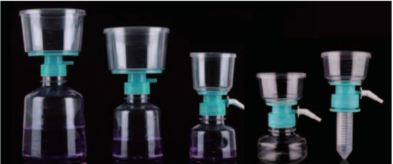
NEST社のボトルトップフィルトレーションシステムは、大量のサンプル分離と組織培養液やその他の生物学的バッファーの滅菌に便利です。PESまたはPVDFメンブレンフィルターのポリスチレン製の目盛付きフィルタートップ、ABS製ネックとポリスチレン製ボトルがセットになっています。保存用の滅菌ポリエチレンキャップが付属しています。ろ過システムは、高透明ポリスチレン (PS) を原料として製造され、50mL/150mL/250mL/500mL/1000mLの3種類の容量があります。ボトルトップ・ボトルのセット、ボトルトップのみ、ボトルのみの3つのスタイルで提供されています。
