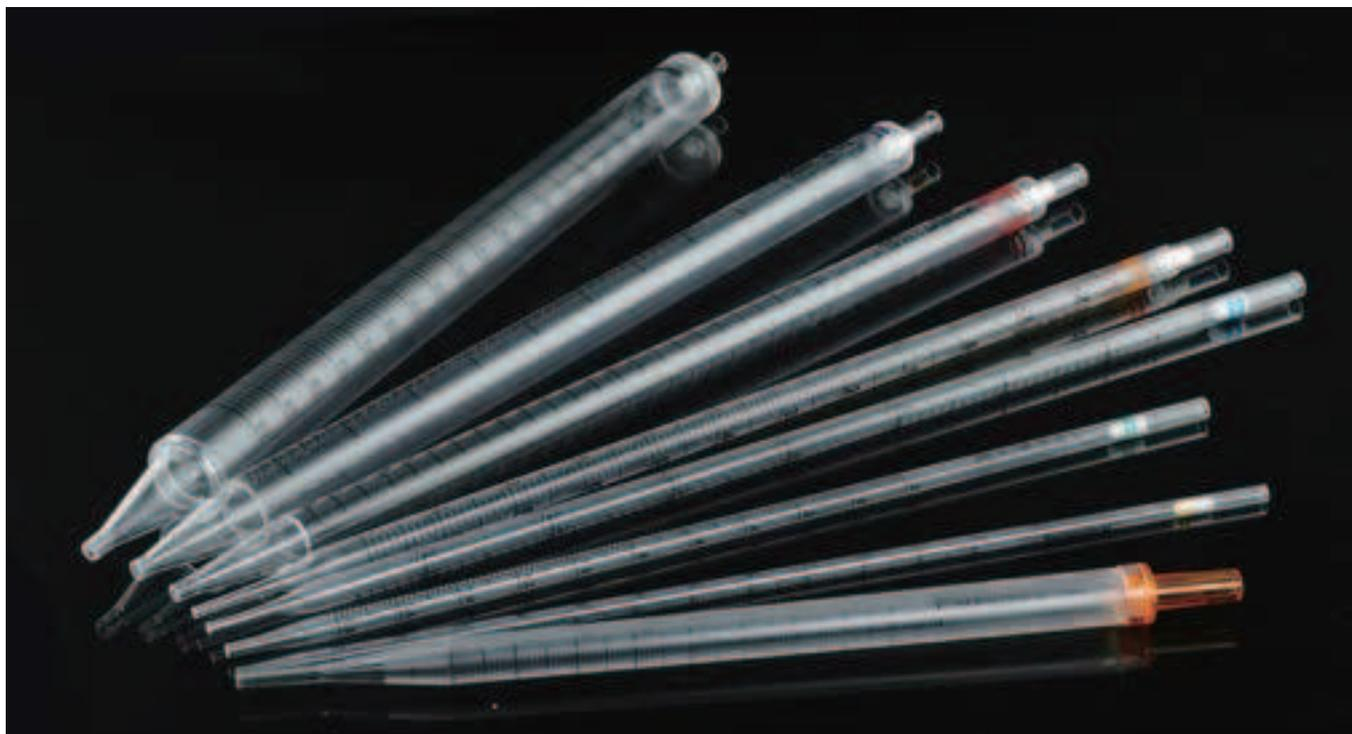
NEST社のプラスチックピペットは、組織培養や細菌培養などの生物学的研究に使用することができます。透明度の高いポリスチレン製で、プラスチック/紙のピールオフバッグに個包装されています。仕様の異なるピペットは、色の違いで区別されます。
