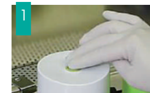
凍結チューブを穴に差し込みます
