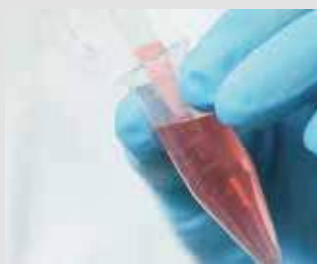
エッペンドルフチューブ5.0 mLは、チップだけを中に入れてピペティングができます。
