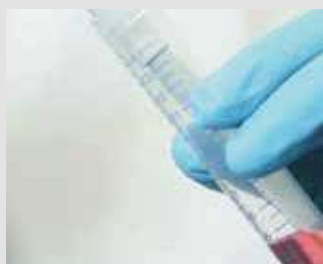
15 mLコニカルチューブではピペット本体がチューブ内壁と接して、コンタミネーションのリスクがあります。
